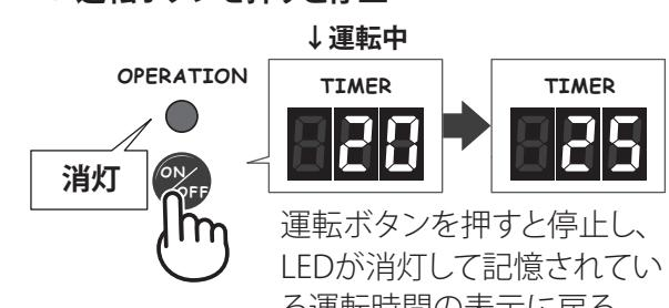
運転ボタンを押すと停止し、LEDが消灯して記憶されている運転時間の表示に戻る。
